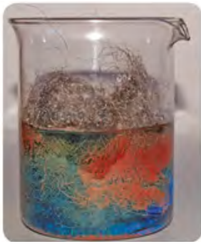
● واکنش الیاف آهن با محلول مس (II) سولفات.
