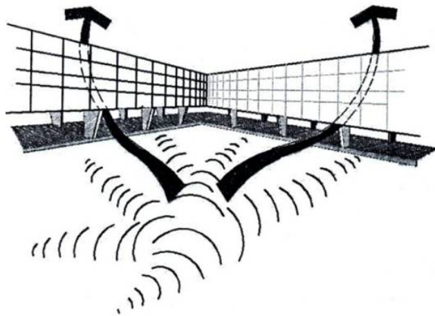
شکل ۲-۲۱-۵- تخلیه موج انفجار از پیلوت باز
